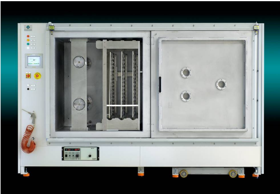
图 2 Europlasma CD650/450 卷对卷装载设备
