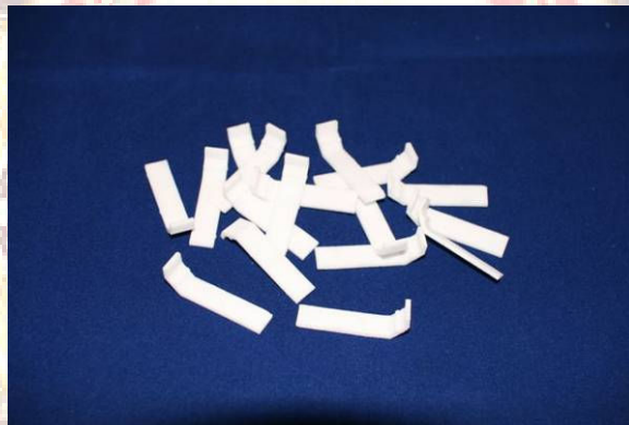
图 5 多孔塑料制成的硬性过滤介质
