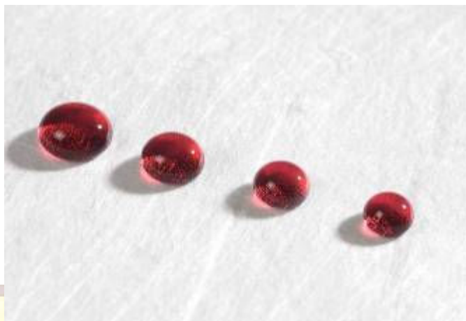
图 8： 涂层熔喷 PP 拒油效果
